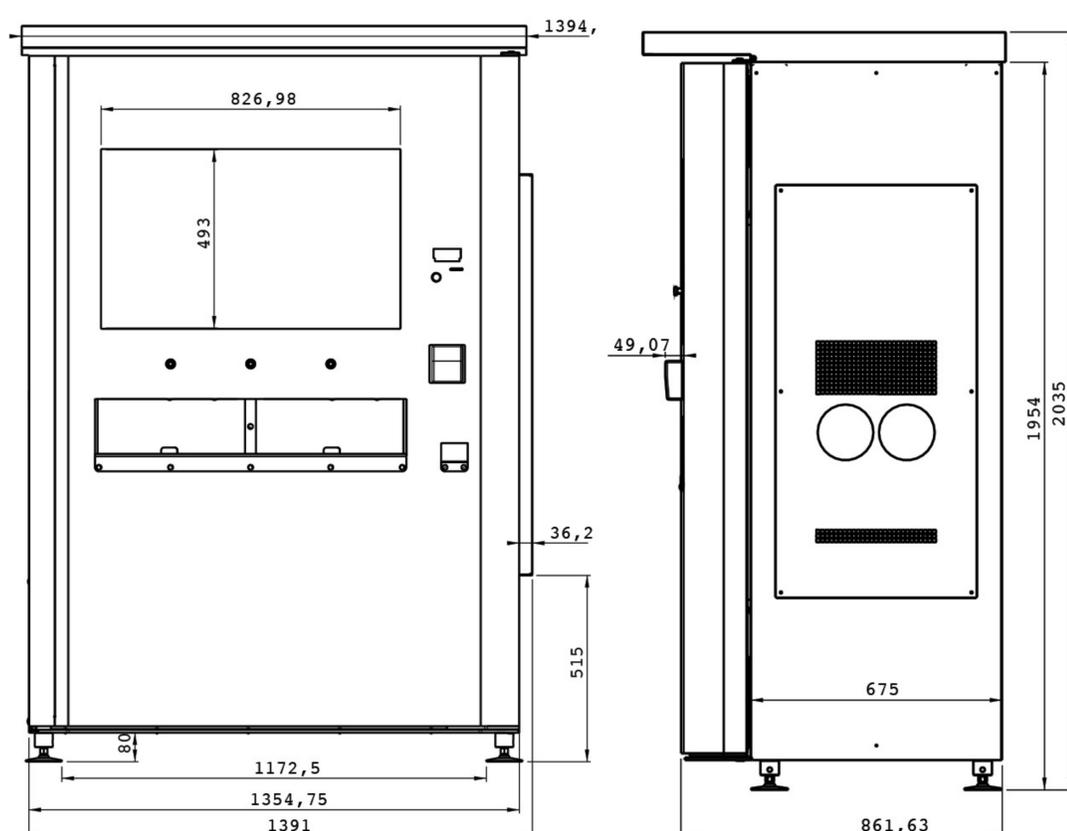
Puissance électrique du distributeur 220V – 1500W. Poids : 550kg.
